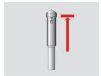
Das überschüssige Seil in den unteren Mastteil gleiten lassen.
